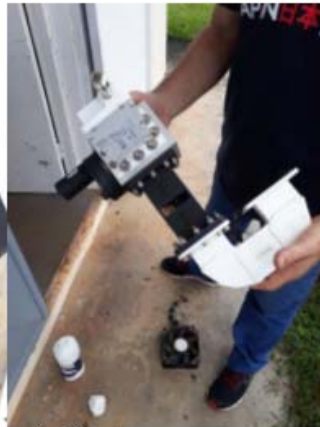
Mantenimiento componentes interior antenna (outdoor) – presencia de insectos
